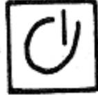
کلید Standby: با فشردن این کلید دستگاه به حالت خاموش موقت می‌رود و آماده بکار می‌باشد. در این حالت یک خط افقی روی نشانگر ظاهر می‌شود. با فشردن کلید انتخاب کانال (گروه A) می‌توان از حالت Standby خارج شد. چنانچه تلویزیون برنامه نداشته باشد پس از ۱۰ دقیقه دستگاه بطور اتوماتیک به Standby می‌رود.
